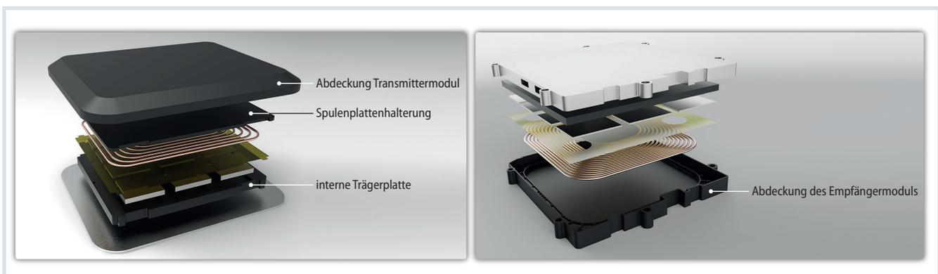
**Bild 2.** Komponenten des Sendemoduls (links) und des Empfängermoduls (rechts) des induktiven Ladesystems: Die Abdeckungen müssen die Elektronik vor Beschädigung schützen und flammhemmende Eigenschaften besitzen. © RadiciGroup
